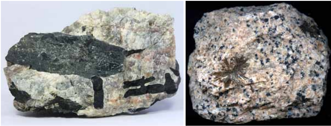
Слева: Призматические кристаллы эгирина в нефелине. 10 × 8 см. Вишнёвые горы, Челябинская область, Урал. Справа: Эгирин-арфведсонитовый метасоматит с астрофиллитом. 6 × 6 см. Катугинское месторождение, Забайкалье. Left: Prismatic crystals of aegirine in nepheline. 10 × 8 cm. Visnyoviye Gory, Chelyabinsk region, Ural. Right: Aegirine-arfvedsonite metasomatite with astrophyllite. 6 × 6 cm. Katuginshkoye deposit, Baikal area.
