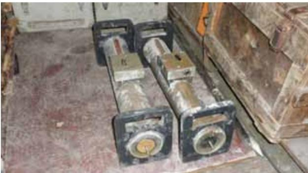
Рис. 6. Индукционные датчики магнитного поля после затопления.
