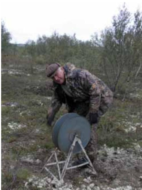
Рис. 9. Помощник оператора А.А. Жамалетдинов за работой. Смотка-размотка приёмных электрических линий на точке АМТЗ.
