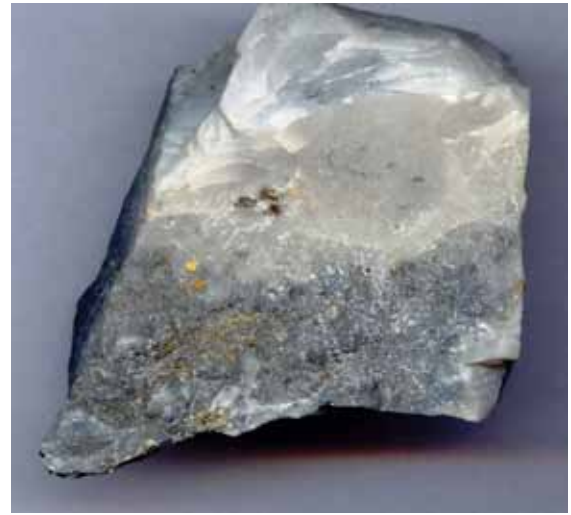
Рис. 33. Мелкозернистый жильный кварц с малым количеством пирита и галенита (с микровросками мелонита и алтаита), с включениями обломков лиственигов с обильным пиритом. По кривым трещинам в кварце примазки мелкозернистого золота (пробность 935). 6 см. Джеламбет-Центр.
