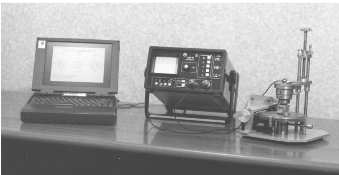
Рис.1. Автоматизированный программно-аппаратный комплекс для изучения физических свойств упруго-анизотропных сред с использованием акустополаризационного метода
