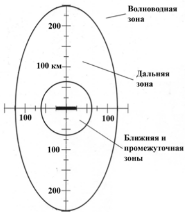
Рис. 1. Различные зоны около кабеля конечной длины ( L=25 км, f=5 Гц, \rho=5000 Ом·м).
