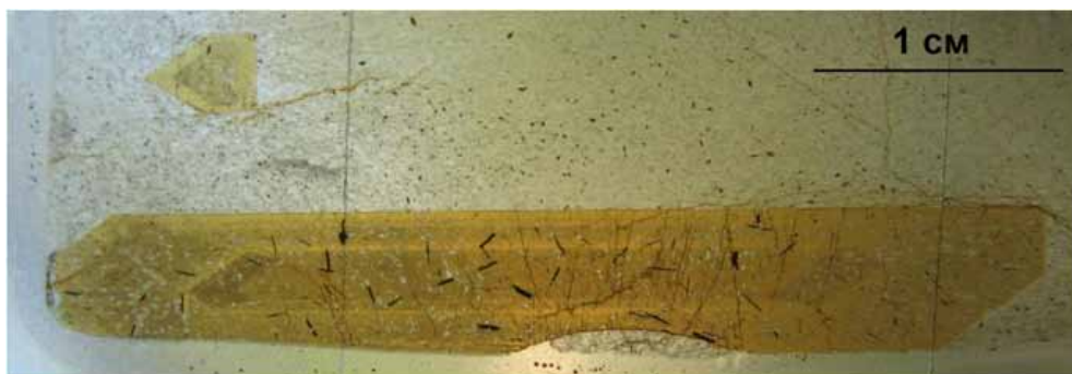
Рис. 4. Длиннопризматический кристалл первого типа (продольный разрез) и зародыш кристалла четвертого типа. Видны фрагменты ядра в разных концах кристалла и две зоны вокруг него. Фото в проходящем свете.
