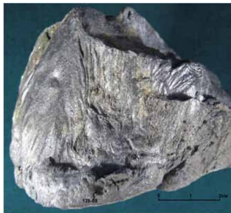
Рис. 2. Слюдяная корка на поверхности конкреции, обусловленная сколом по мусковит-графит-кварцевому прожилку.
