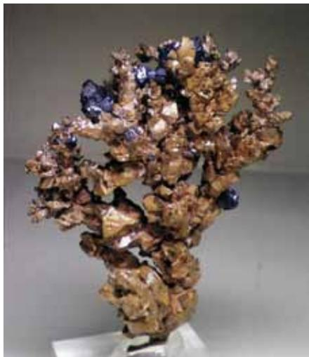
Рис. 2. Самородная Сu с купритом из Рубцовского месторождения, размер образца 6 см [4].
