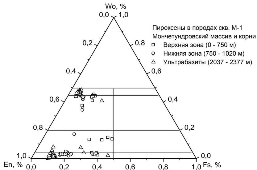
Рис.5.2. Состав пироксенов в интрузивных породах скв. М-1 по данным микронзондового анализа
