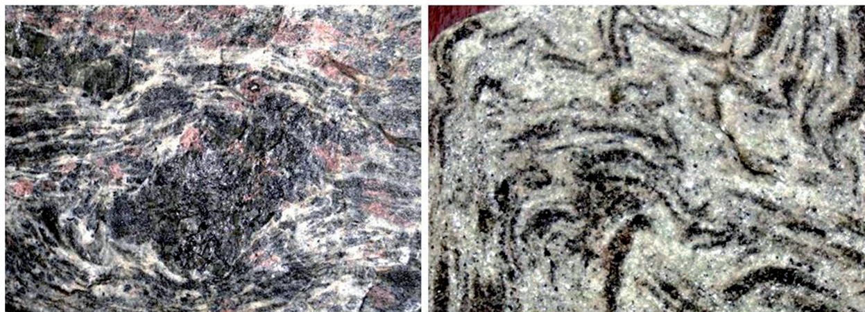
Рис. 1. Примеры вязкопластической и пликативной тектоники в апатит-нефелиновых рудах. Fig. 1. Examples of viscous flow and plicative tectonics in apatite-nepheline ores.
