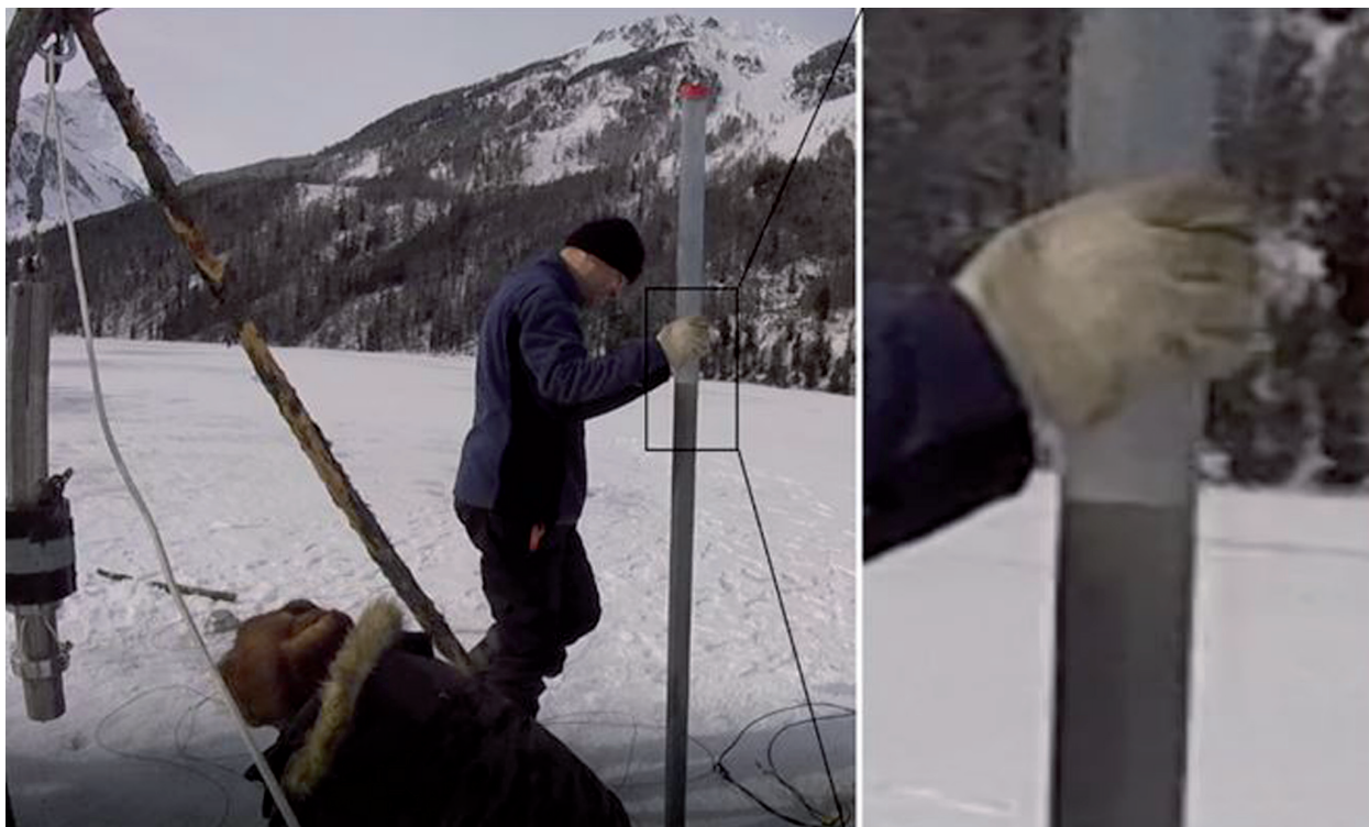
Рис. 2. В процессе пробоотбора особое внимание обращалось на сохранность верхней границы и ненарушенность границы вода–осадок.
