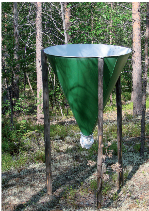
Рис.1. Коллектор для сбора опада (опадоуловитель). Fig. 1. Collector for sampling litter (litter trap).
