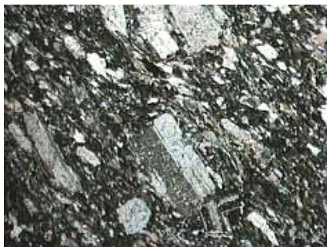
Рис. 3. Реликтовые порфировые вкрапленники плагиоклаза. Шлиф 303/123 м. Слева – без анализ., справа – с анализ.
