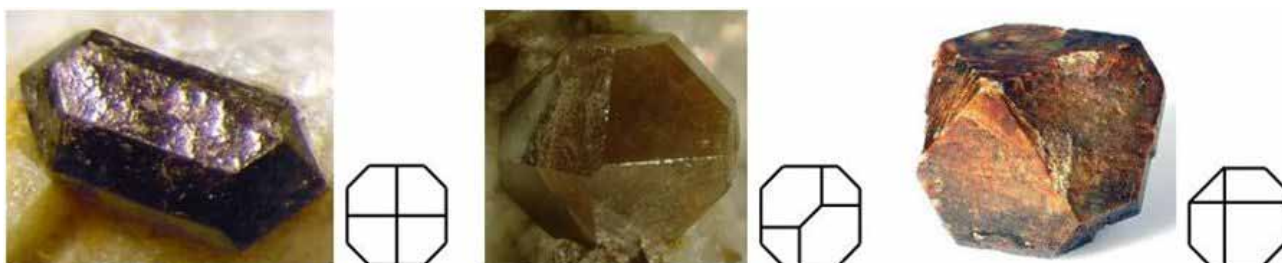
Рис. 6. Одновершинные формы четвертого типа на кристаллах циркона.
