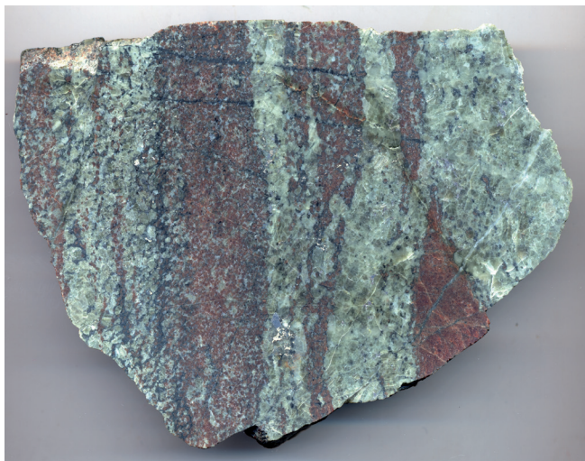
Рис. 2. Образец гранат-клинопироксеновой породы с характерной полосчатой текстурой: слои зеленого цвета сложены преимущественно клинопироксеном, коричневого - гранатом. Содержание сульфидной минерализации в этом образце варьирует в различных прослоях.
